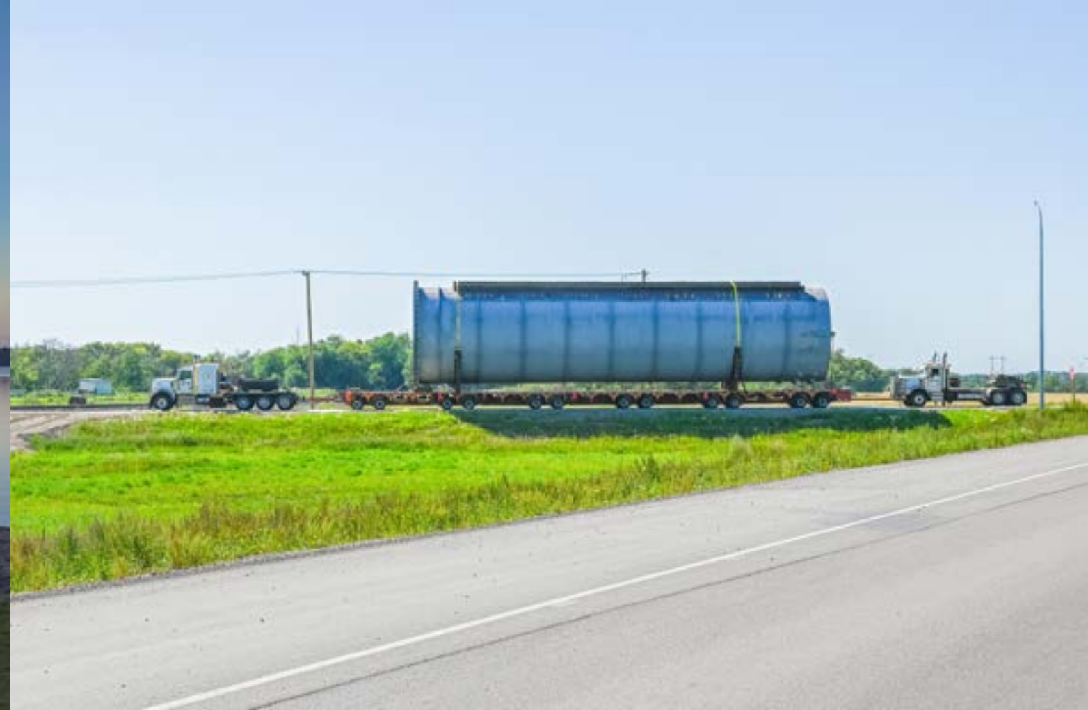
Oben; Bild 89: Schwerlasttransport mit Zug- und Schubfahrzeug
